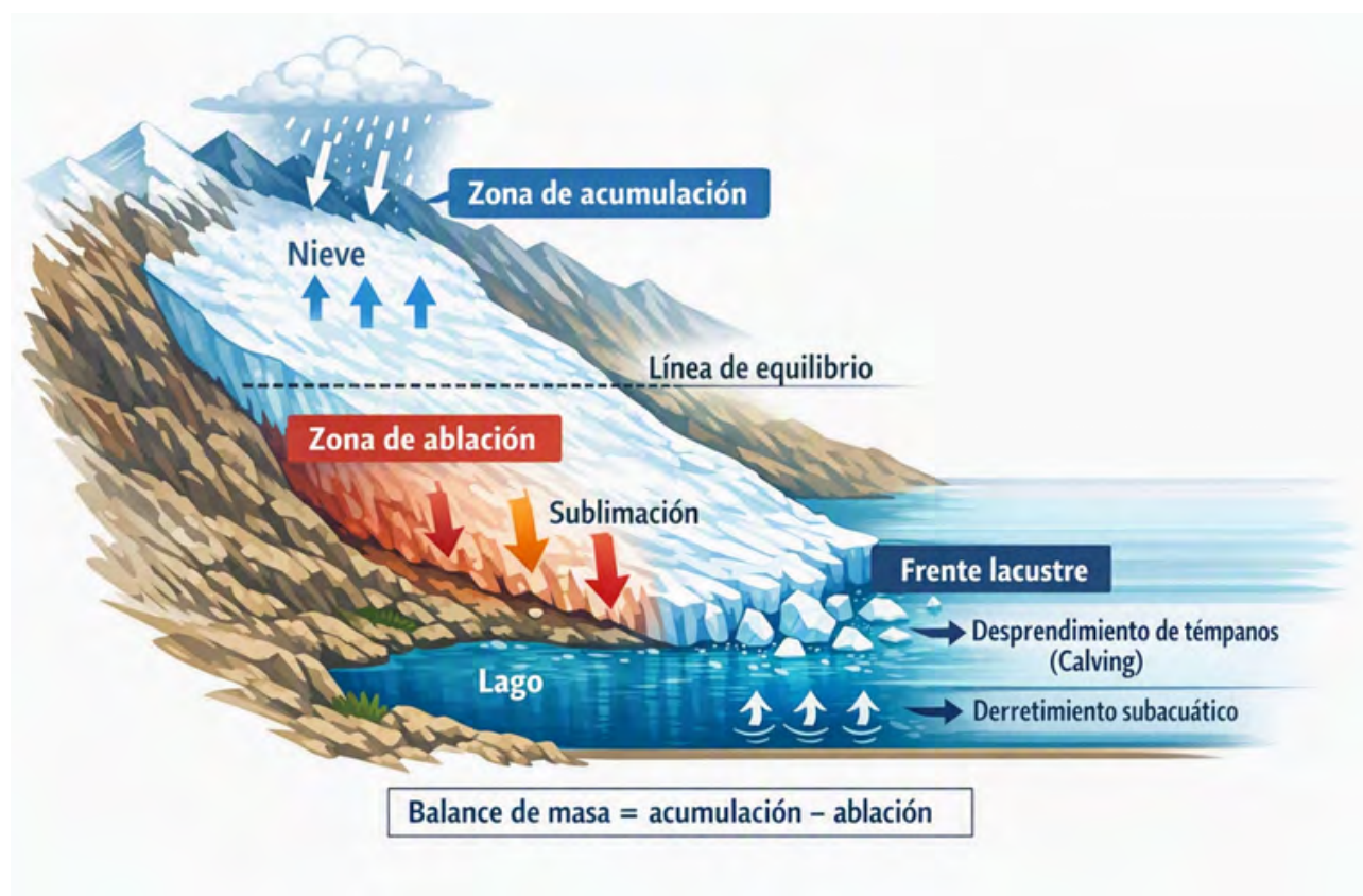
Figura 2. Esquema del balance de masa de un glaciar. La zona de acumulación representa las ganancias de nieve y hielo; la zona de ablación concentra las pérdidas por fusión, sublimación, escorrentía y, en glaciares lacustres, desprendimiento de témpanos y derretimiento subacuático.
